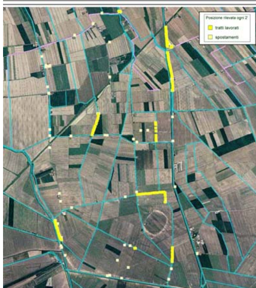
Traccia degli spostamenti di un trattore con braccio decespugliatore, relativi ad una giornata lavorativa (si possono distinguere ben 7 diversi tratti lavorati)
